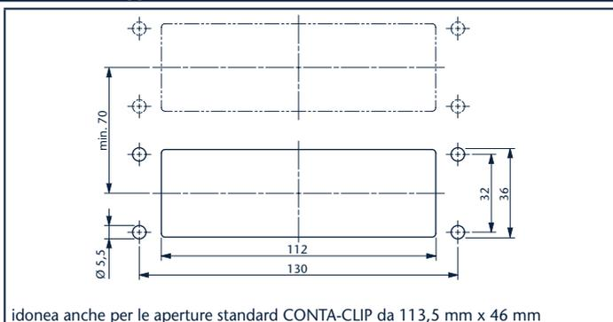
idonea anche per le aperture standard CONTA-CLIP da 113,5 mm x 46 mm
