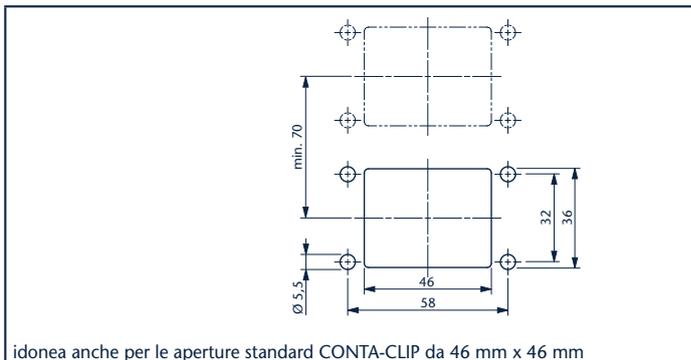
idonea anche per le aperture standard CONTA-CLIP da 46 mm x 46 mm
