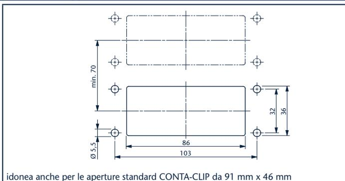
idonea anche per le aperture standard CONTA-CLIP da 91 mm x 46 mm
