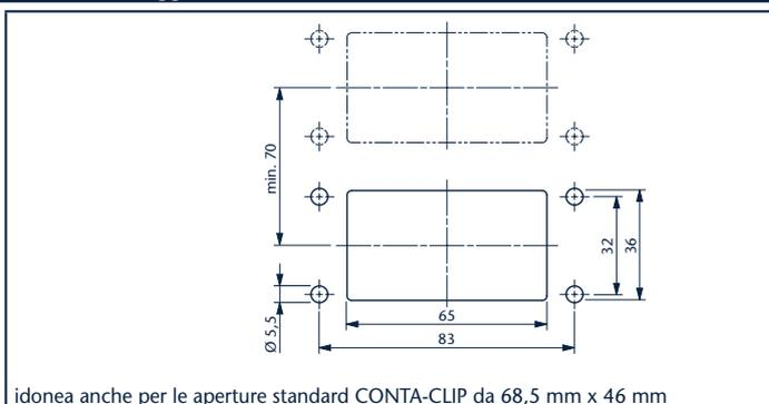
idonea anche per le aperture standard CONTA-CLIP da 68,5 mm x 46 mm
